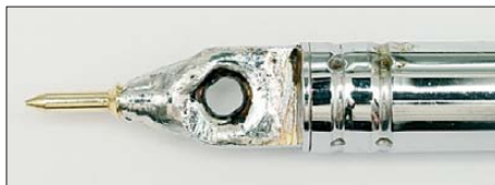
Bild 4: Zum Anschluss an den BNC-Adapter wird am Fußpunkt der Teleskopantenne der Kontaktstift aus einem BNC-Stecker angelötet.
