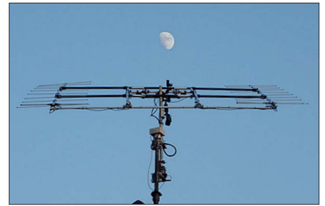
Steffen, DD0VF, hat sich für seine zwei Yagi-Antennen eine sehr elegante mechanische Struktur überlegt und diese umgesetzt.
