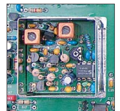
Bild 10: ZF-Verstärker im Weißblechgehäuse auf der Grundplatte
