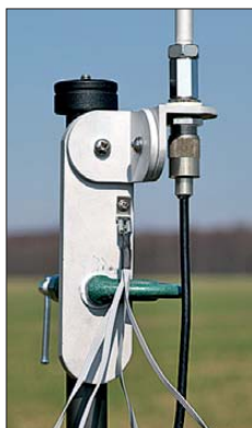
Bild 5: Montagewinkel mit Antenne, Koaxialkabel und vier Radialen
