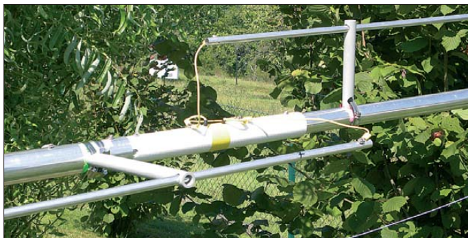
Bild 1: Isoliertes Mittelstück und Befestigung der äußeren Aluminiumrohre
