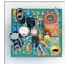
Bild 10: ZF-Verstärker im Weißblechgehäuse auf der Grundplatte
