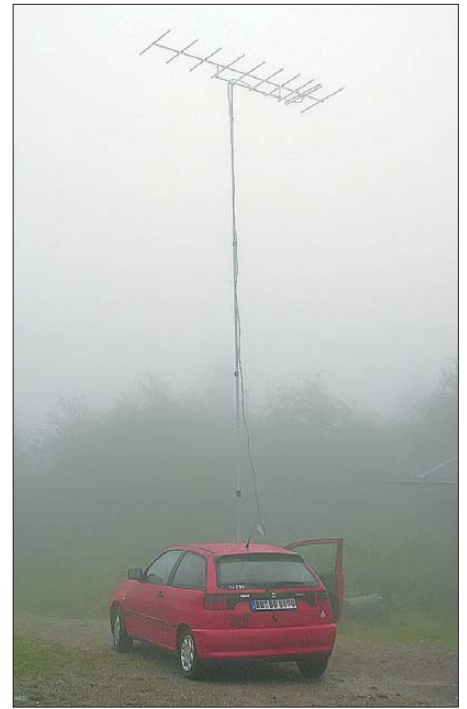
Bild 3: DJ3TZ/p beim Funkbetrieb aus dem Auto; der verwendete Bleigel-Akkumulator schont die Autobatterie. An diesem Abend gelang vom Schwarzwald aus auf 2 m eine Funkverbindung nach Südschweden.
