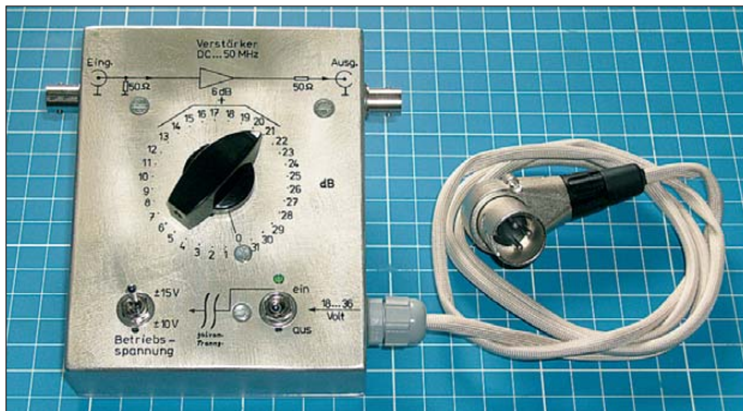
Bild 1: Fertigerät des Breitbandverstärkers mit Dezibel-linearer Einstellmöglichkeit über einen Drehcodierschalter
