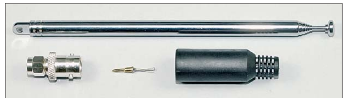
Bild 2: Aus diesen Einzelteilen besteht die Teleskopantenne des DJ-G7.
