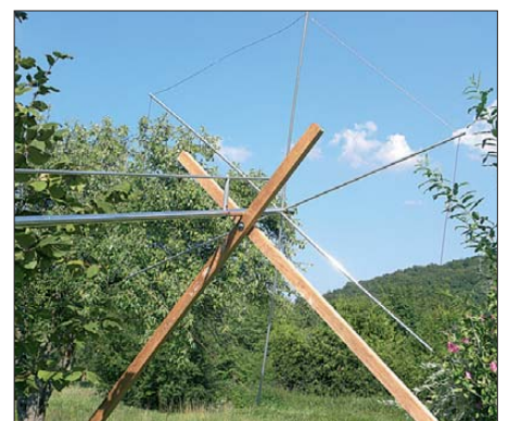
Bild 2: Aufbau der Dachkapazität
