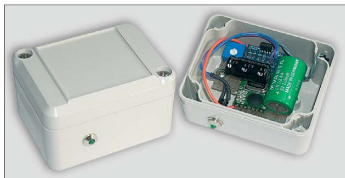
Bild 1: Batteriebetriebene Funksensoren im geschlossenen und geöffneten Gehäuse Fotos, Screenshots: Riedel
