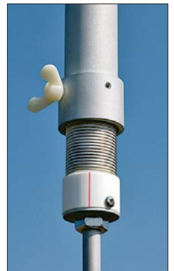
Bild 3: Der Zylinder lässt sich auf der Spule für ein niedriges SWV verschieben.
